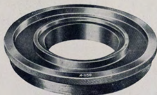
A-1150 - Piastra per estrarre e introdurre il cuscinetto del semiasse con l'estrattore A-1122. (Fig. 484 - pag. 226).
