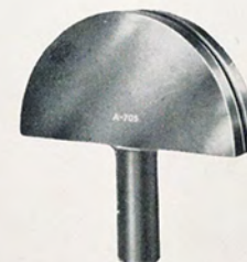
A-705 - Punzone per montaggio semianelli ritegno cuscinetto. (Fig. 413 - pag. 200).
