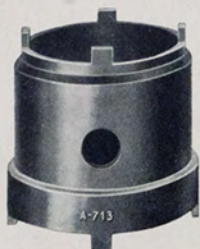
A-713 - Chiave per ghiera ingranaggio primario marce ridotte e normali. (Fig. 390 - pag. 191).
