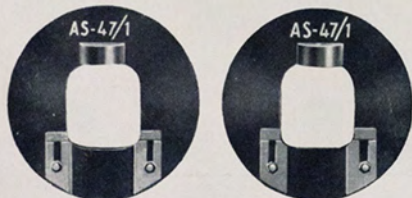
AS-47/1 - Dischi da montare sulla scatola ponte posteriore per il montaggio sul cavalletto. (Fig. 447 - pag. 216).
