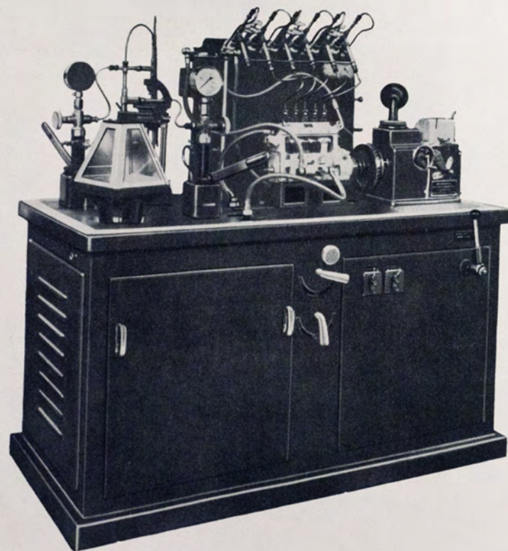
A-593 - Banco prova pompe iniezione e iniettori. (Figg. 197 a 218 - pagg. 107 a 119).
