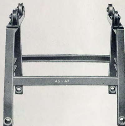
AS-47 - Cavalletto per revisione ponte posteriore. (Fig. 445 - pag. 216).
