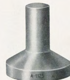
A-1125 - Punzone montaggio anello cuscinetto per albero pignone riduttore. (Pag. 231).
