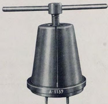
A-1139 - Estrattore per cuscinetto del pignone conico differenziale. (Fig. 480 - pag. 224).
