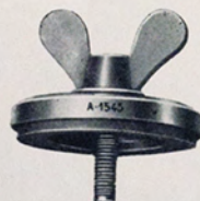
A-1545 - Particolari da montare sui radiatori per prova di tenuta. (Fig. 170 - pag. 90).
