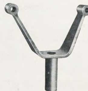
AS-13 - Supporto per montaggio cambio sul cavalletto AS-45. (Fig. 344 - pag. 175).
